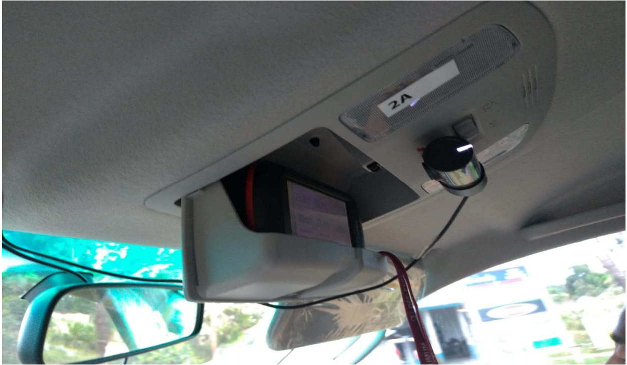
Ket : Penyetelan Alat GPS Garmin untuk Survey Kondisi Jalan dengan P/KRMS
